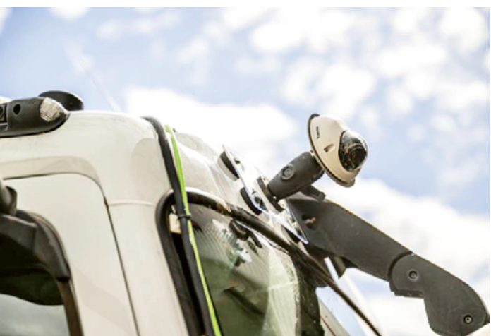
Caméra 3 IA sur un véhicule de Bruxelles-Propreté
