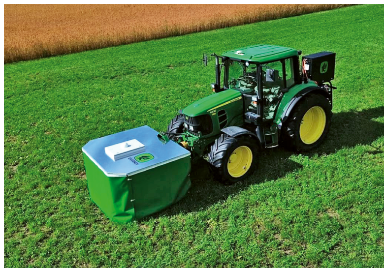
La fourche à adventices électrique (FAE) / Die elektrische Blackengabel
